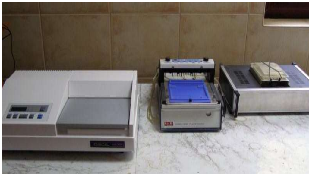
Fig. 8.18. Complex de determinare spectrofotometrică pentru metabolism intermediar
